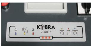
Elegante ed intuitivo pannello Touch Screen con indicatori ottici luminosi e Sistema FCS a LED per il controllo del carico.
