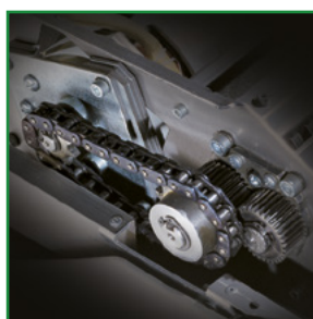
Super Potential Power Unit スチールギアを採用したチェーン ドライブシステム。
