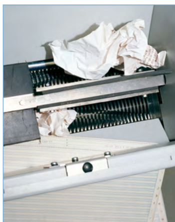
Sistema di alimentazione automatico a pale rotanti.
