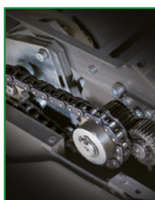
Trasmissione a catena con ingranaggi in acciaio.
