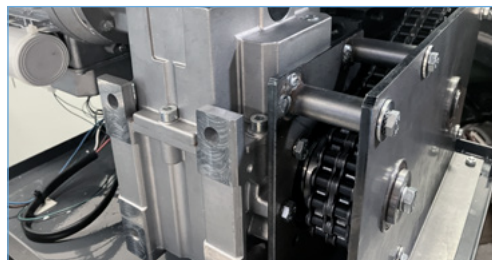
Il modello Kobra HDD è equipaggiato con il motoriduttore in acciaio "Titan- Colossus" in grado di distruggere grandi quantità di dispositivi rotazionali e multimediali digitali come: Dischi Rigidi fino a 3.5", Solid State Drives (SSD), LTO, Ultrium, Nastri magnetici fino a 3.5", CD, DVD, Dischi Blu-ray, Carte di credito e Carte di identità, Chiavette USB e Dispositivi a stato solido (Cellulari e Tablet).
