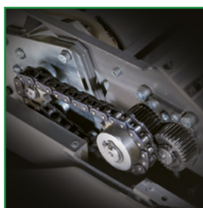
Trasmissione a catena con ingranaggi in acciaio.
