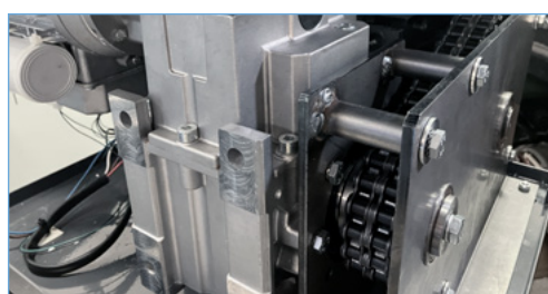
Il modello Kobra DIGITAL-PRO è equipaggiato con il motoriduttore in acciaio "Titan-Colossus" in grado di distruggere grandi quantità di: SSD (anche con case in metallo), smartphone, schede SIM, chiavette USB, chip di memorie flash IC, carte di credito con chip, schede elettroniche, CD/DVD.
