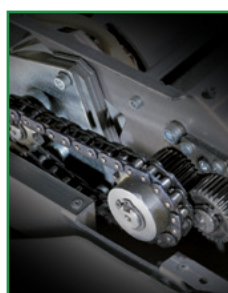
Trasmissione a catena con ingranaggi in acciaio.
