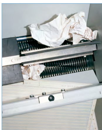
Sistema di alimentazione automatico a pale rotanti.
