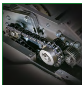
Trasmissione a catena con ingranaggi in acciaio.
