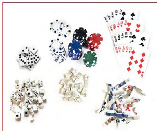
Esempi di materiali distrutti: frammenti da 12,5 x 20 mm di dadi e fiches in plastica, frammenti da 12,5 x 20-88 mm di carte da gioco.
