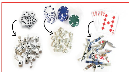
Esempi di materiali distrutti: frammenti da 12,5 x 20 mm di dadi e fiches, frammenti da 12,5 x 20-88 mm di carte da gioco.
