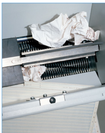
Sistema di alimentazione automatico a pale rotanti.
