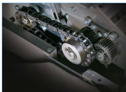
Super Potential Power System: ingranaggi in acciaio e trasmissione a catena.
