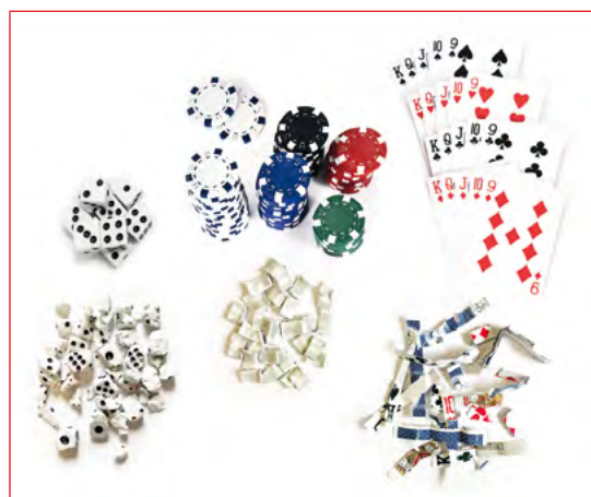
Esempi di materiali distrutti: frammenti da 12,5 x 20 mm di dadi e fiches in plastica, frammenti da 12,5 x 20-88 mm di carte da gioco.
