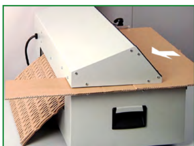
Facile da usare: larghezza dell'entrata cartone regolabile. Taglia in automatico cartoni di larghezza superiore alla luce d'entrata.
