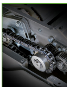
Trasmissione a catena con ingranaggi in acciaio.
