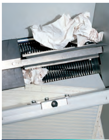
Automatický systém mechanického podávání využívá otočné klapky k podávání materiálu do řezných nožů.
