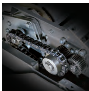
Řetězový pohon s ocelovými převody.
