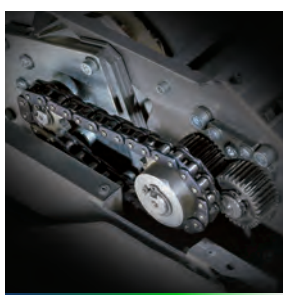
Řetězový pohon s ocelovými převody.
